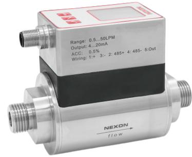
根据法拉第电磁感应原理当一个导体垂直经过磁场**B**时，将会感应出一个电压。**U**在该流量计的测量中，移动导体是流动的导电介质，磁场**B**自垂直于流动介质的方向被发射出来，在E1, E2两个电极上的感应电动势**U**直接正比于介质的流速**V**。
