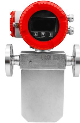
VN系列科氏质量流量计是NEXON新一代微弯型双流量管科氏质量流量计。配有基于数字信号处理（DSP）的电子转换装置，集传感器的数字闭环振动控制（DLC）、信号处理、计算和诊断功能于一身，具有测量精度高、量程比宽、可靠性高的优点。可与手操器通过HART，或与PC通过Modbus通讯，直接对其进行在线节点配置、故障诊断和数据记录。
