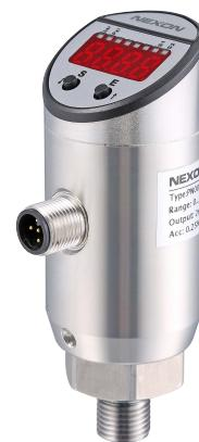
PN3000系列采用陶瓷传感器进行压力测量,信号由后部处理电路处理后转换标准工业电信号输出并显示。全金属外壳设计,采用高亮型LED数字显示,使得该系列产品能够被用于各种工业场合。双键设计和用户友好的菜单使产品使用更加方便。多种连接方式可以充分满足各种特定的安装需求。可330°旋转的显示头能保证在不同安装方式下获得最佳的观察角度。
