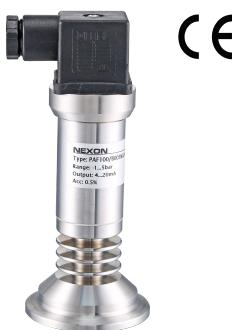
PAF100系列不锈钢薄膜传感器(>10bar)进行压力测量,信号由后部处理电路处理后转换成标准工业电信号输出。全金属外壳设计,使得该系列产品能够被用于各种工业场合。
